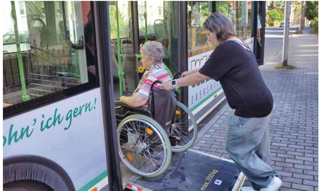
Im Stadtverkehr Eberswalde sind alle 12 Oberleitungsbusse mit Niederflertechnik und speziellen Rollstuhlrampen ausgerüstet. Bei den Neuanschaffungen unseres Fuhrparks wurde in den vergangenen Jahren vorrangig diese Niederflertechnik angeschafft. 95% unserer Busse sind Niederflurfahrzeuge. In den Fahrzeugen wird auf ausreichend große Stellflächen für Rollstuhlfahrer und die zunehmende Anzahl von Fahrgästen mit Rollatoren geachtet. Um einen einfachen Ein- und Aus-
