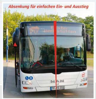
In diesem Sinne beschaffen wir neue Niederflurfahrzeuge, die einen einfachen Ein- und Ausstieg sowie einen barrierefreien Aufenthalt ermöglichen. Der Ausstatungsgrad bezogen auf die gesamte Fahrzeugflotte liegt derzeit bei über 60 Prozent - mit steigender Tendenz.
