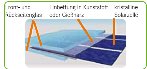
Aufbau eines Solarmoduls: Glas-in-Glas-Technik
