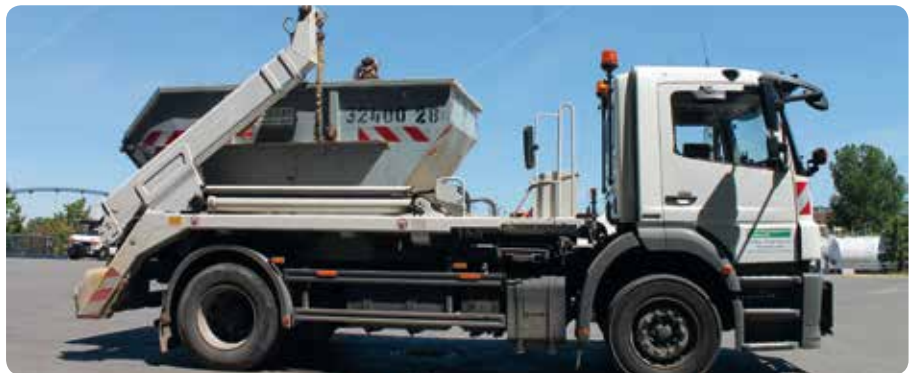
Absetzkipperfahrzeug mit einem 7 m 3 Container, z. B. für Bauschutt
